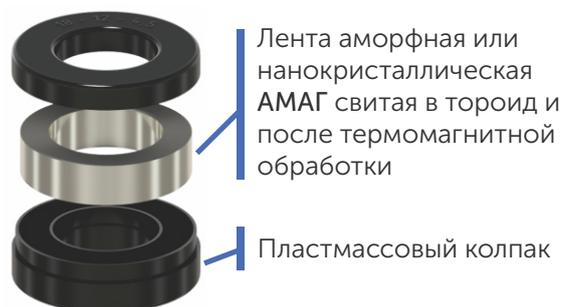
ПАО «МСТАТОР» производит широкий ряд витых тороидальных магнитопроводов (ссылка) с внешним диаметром от 3 до 200 мм, высотой от 0,7 до 30 мм из аморфных и нанокристаллических лент АМАГ, а также электромагнитные компоненты на их основе.
