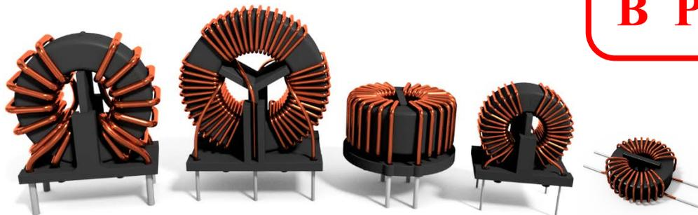
Синфазные дроссели **серий ДС2 и ДС3** для подавления радиопомех производства ПАО «МСТАТОР» на основе тонкой (16±18 мкм) нанокристаллической ленты АМАГ 200С обеспечивают высокий уровень подавления помех и характеризуются малыми габаритными размерами и весом по сравнению с дросселями на ферритовом сердечнике.
