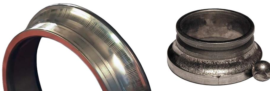
Рис. 1 – Типичные примеры повреждения подшипников (fluting / рифление)
