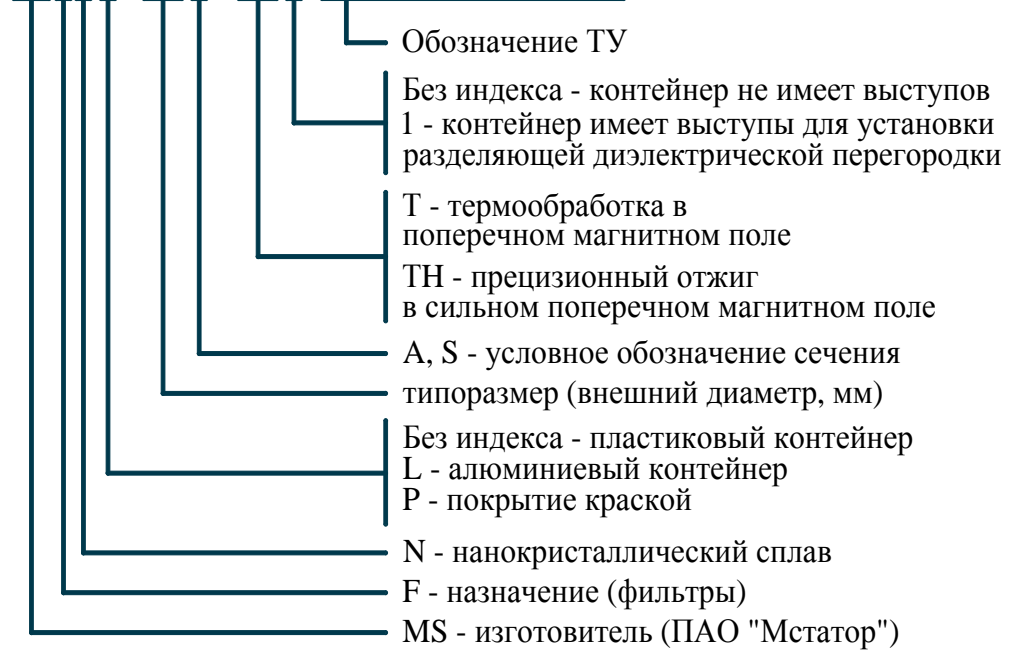
Рисунок 3.1 – Обозначение магнитопроводов
