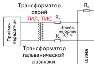
Выбор трансформатора гальванической развязки зависит от амплитуды выходного сигнала приёмопередатчика
