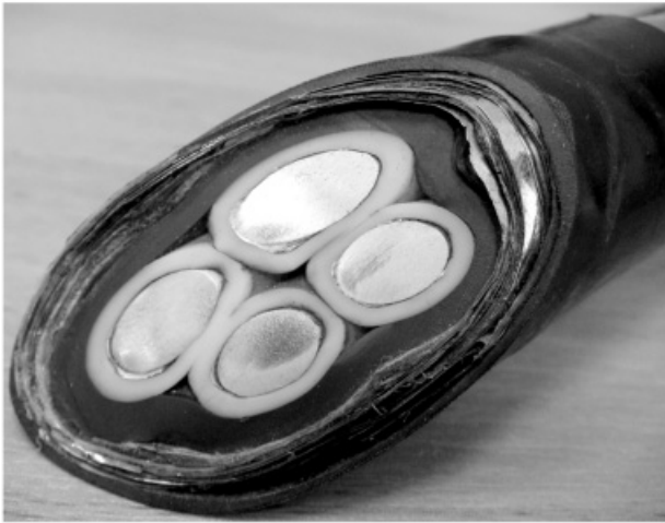
Рис. 8. Общий вид магнитного экрана для силового кабеля
